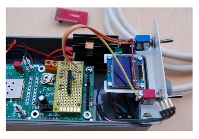
Au centre du circuit à pastilles, le connecteur pour l'interface USB - TTL 5V (celle-ci est visible au dessus du coffret. A droite, une cornière PVC supporte les deux inverseurs PTT et PD.
