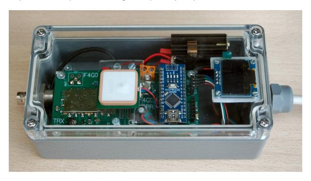
L'inversion du sens des deux boulons de 3x20 mm permettra de déposer la platine supportant le GPS en ôtant simplement 2 écrous. Il sera même possible de repositionner la platine à l'extérieur du boîtier en se servant de l'un des boulons :
